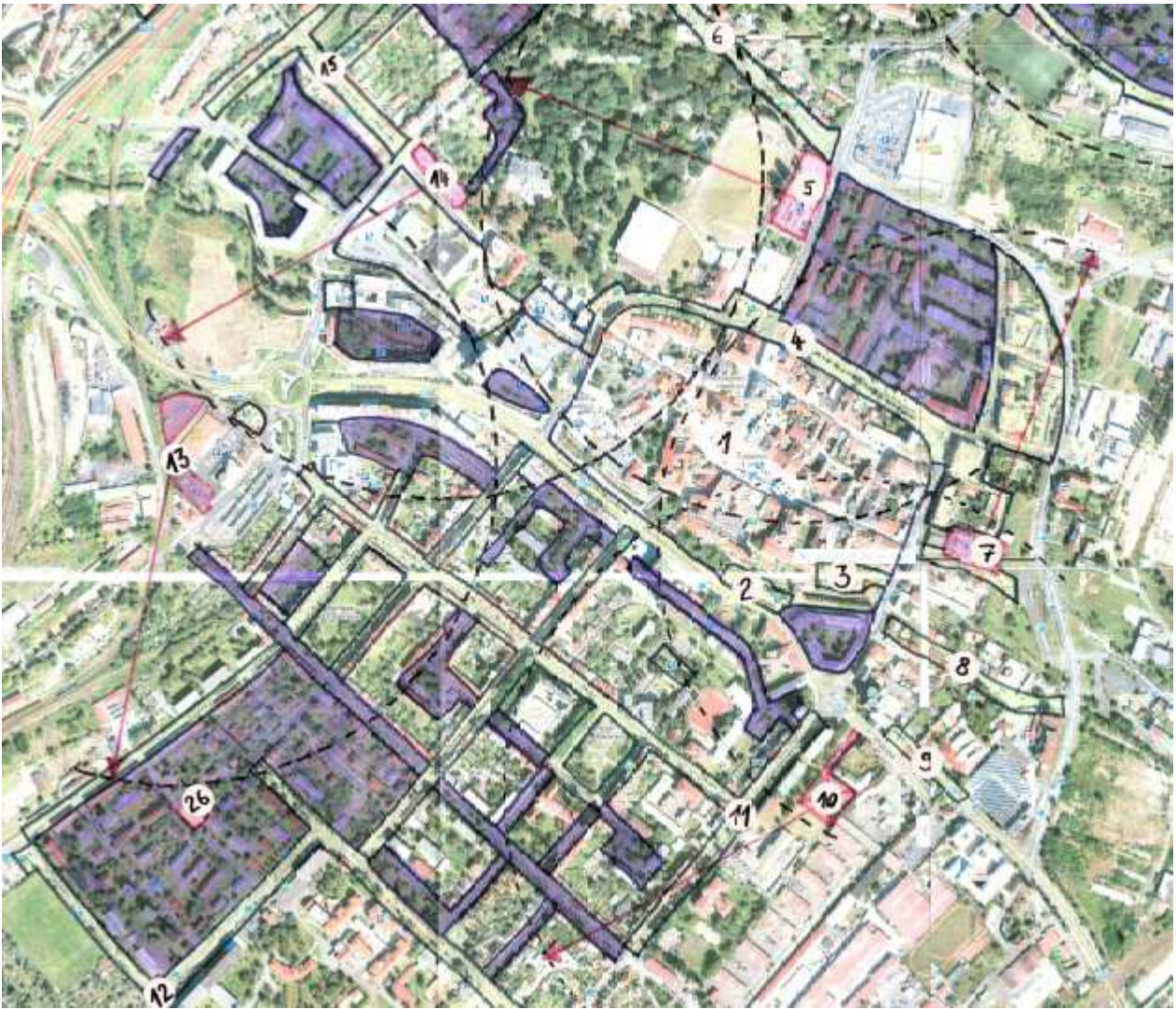
Obrázek 52: Návrh řešení statické dopravy pro centrum města Chomutov a navazující území; /zdroj: Parkovací politika Chomutov 2019+
