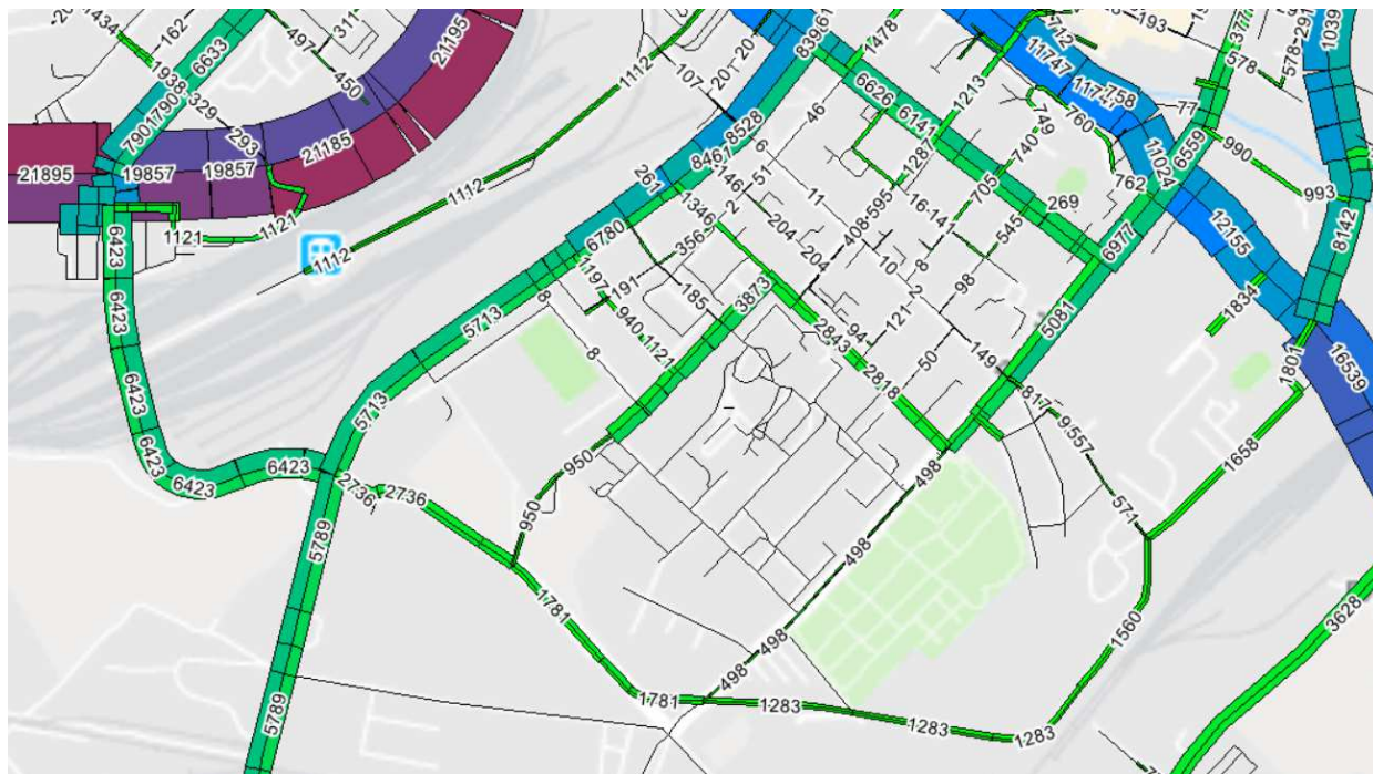
Obrázek 17: VPS Vnitřní městský okruh; dopravní model, zatížení ve vozidlech za 24 hodin, rok 2030
