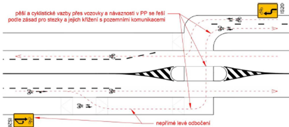
Obrázek 103: Příklad napojení stezky na vozovku s nutností zastavit, s využitím nepřímého levého odbočení dle TP 179
